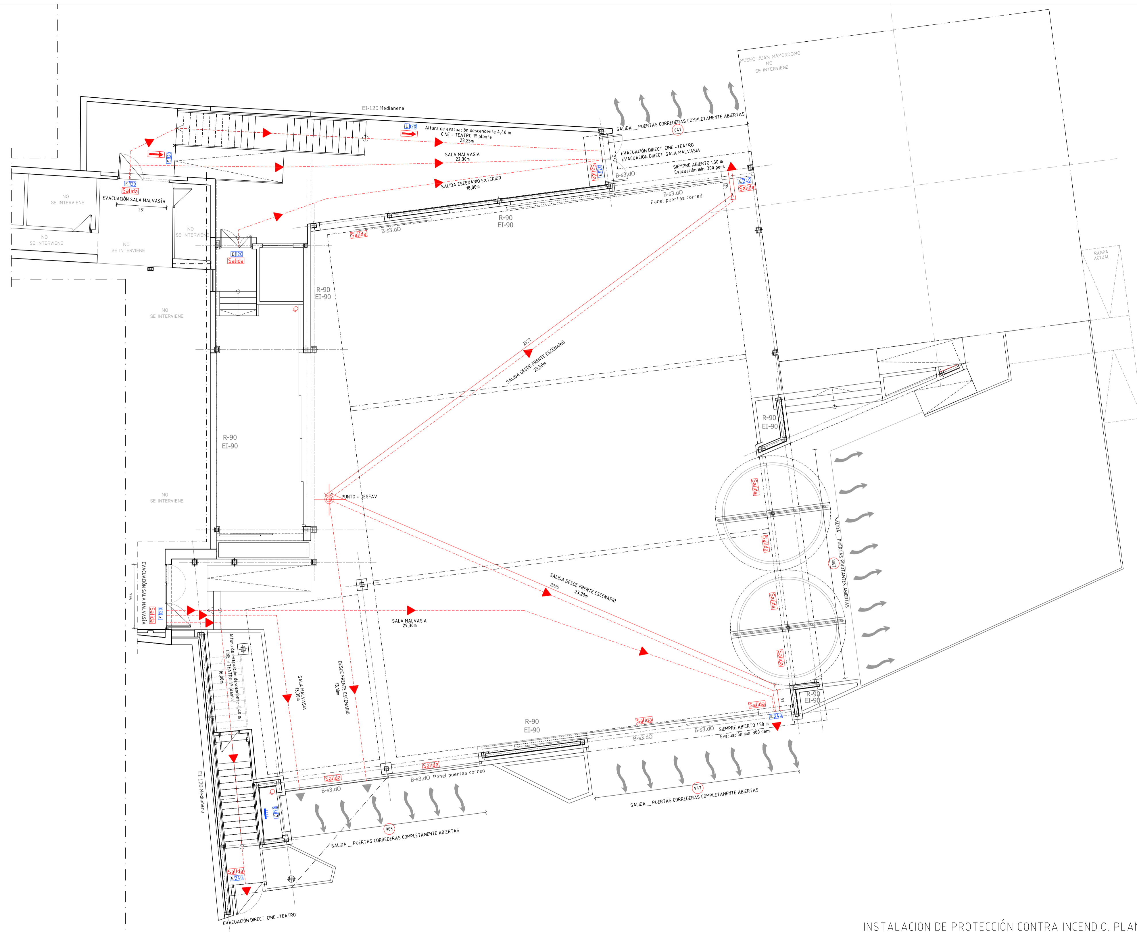
INSTALACION DE PROTECCIÓN CONTRA INCENDIO. PLANTA BAJA.
